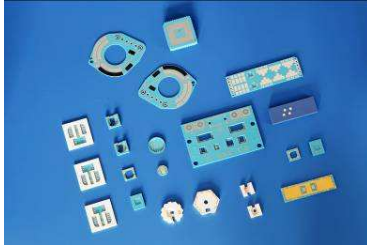
Bild Nr. 44836: LTCC: Low Temperature Cofired Ceramics werden bei vergleichsweise niedrigen Temperaturen von 850-900°Celsius gesintert. Dabei lassen sich auch passive elektronische Komponenten einarbeiten. Quelle: SCHOTT
