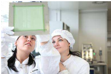
Bild Nr. 44838: „Greensheets“: Qualitätskontrolle bei den Vorprodukten für die Fertigung von Multilagenkeramiken. Quelle: SCHOTT
