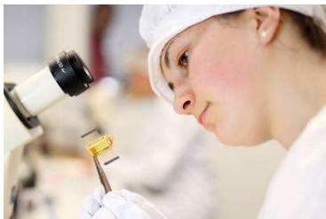
Bild Nr. 44837: Finale Qualitätssicherung: Ein „Butterfly“-Gehäuse von SCHOTT Electronic Packaging bietet hermetischen Schutz für sensible elektronische und opto-elektronische Bauteile. Quelle: SCHOTT
