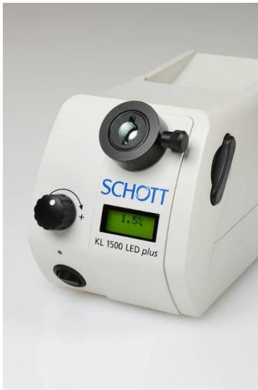
Bild Nr. 46704. KL 1500 LED plus ist eine LED Lichtquelle für Anwendungen in der Stereomikroskopie. Quelle: SCHOTT
