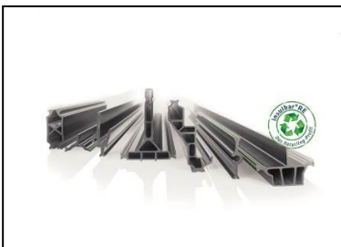
Bild 2: insulbar LEF: Das Wärmedämmprofil nutzt eine Low-E-Folie, die Wärmestrahlung reflektiert. Außen- und Innenschalen von Metallrahmen bei Fenster, Türen und Fassaden werden dadurch optimal thermisch getrennt.
