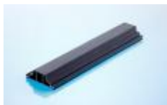
Bild 4: Staubstrahlung des insulbar ESP Wärmedämmprofils – erkennbar an der matten, leicht angerauten Oberfläche – erhöht die Oberflächenspannung des Polyamidsteges und gewährleistet so eine langanhaltende Lackhaftung.
