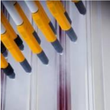
Foto 2: Pulverizado del polvo de color cargado eléctricamente en el perfil del marco de una ventana. (Fuente de la foto: WICONA)
