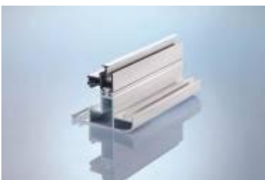
Foto 3: Perfil ensamblado con perfil termoaislante insulbar ESP lacado: El acabado de la capa de laca ha de ser perfecto, especialmente en perfiles con perfil termoaislante visible.
