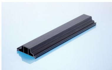
Figure 4 : Le microsablage de la barrette d'isolation thermique insulbar ESP, reconnaissable à la surface mate légèrement rugueuse, augmente l'énergie superficielle de la barrette en polyamide et assure ainsi une adhérence de la laque haute durabilité.
