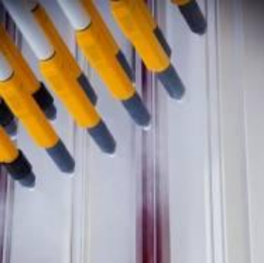
Resim 2: Elektrik yüklü boya tozunun bir pencere çerçevesi profiline püskürtülmesi. (Resim kaynağı: WICONA)
