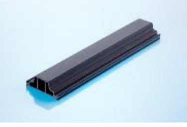
Resim 4: insulbar ESP ısı yalıtım profilinin toz püskürtmesi – mat ve hafif pürüzlü yüzeyden anlaşılır – Polyamid çubuğun yüzey gerilimini artırır ve bu sayede kalıcı bir boya tutunması sağlar.
