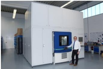
图片 1: Poppe + Potthoff 机械制造公司研发了一款独特的脉冲压力试验台，可用于在正负压力和温度环境下测试创新元件。
