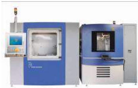
Foto 1: Mit Klimakammern ausgestattet, reicht die Druckanpassung bei der PPM 278-00 von Poppe + Potthoff von -0.8 bis +3.5 bar bei einer Prüf-Frequenz von 0.5 Hz und einem Test-Volumen von 15 dm 3 . Quelle: Poppe + Potthoff
