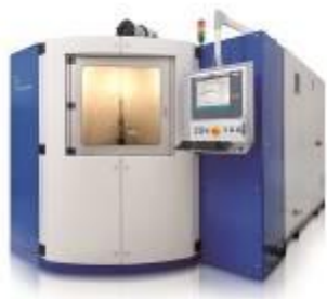
Abb. 3: Dieser Prüfstand von Poppe + Potthoff Maschinenbau erzeugt starke Impulse bis 6.000 bar mit einer Frequenz zwischen 1 und 30 Hz, um die Langlebigkeit und Festigkeit von Bauteilen unter pulsierendem Innendruck zu prüfen.
