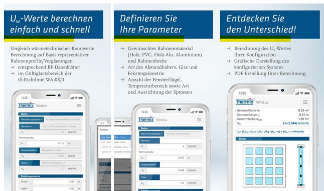
Bild 1: Mit Thermix WinUw können Fensterbauer, Energieberater, Planer und Architekten den Wärmedurchgangskoeffizienten ( U_w ) eines Fensters einfach berechnen, um die Konfiguration hinsichtlich der Energieeffizienz zu optimieren.
