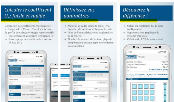
Photo 1 : Grâce au Thermix WinUw, les fabricants de fenêtres, conseillers en énergie, bureaux d'étude et architectes peuvent calculer simplement le coefficient de transmission thermique ( U_w ) d'une fenêtre pour optimiser la configuration en termes d'efficacité énergétique.
