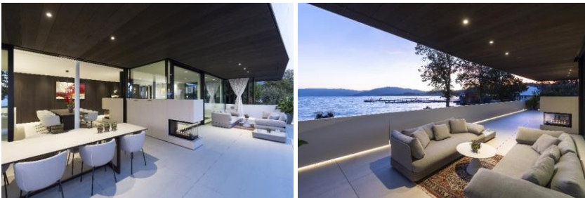
Abb. 18 und 19: Die überdachte Terrasse, ausgelegt mit großformatigem (bis zu 140 cm x 140 cm bei 3 cm Stärke) Dekton Danae, bietet einen grandiosen Ausblick über den Attersee.
