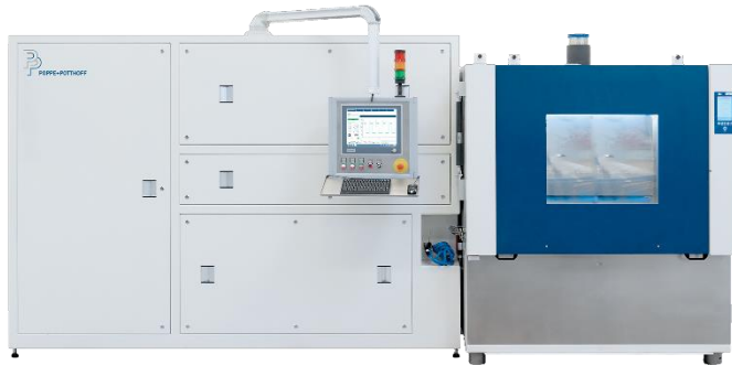
Abb. 1: Komponenten für flüssigkeitsgekühlte Systeme in Rechenzentren werden mit dem Druckwechselprüfstand vom Poppe + Potthoff Maschinenbau getestet.
